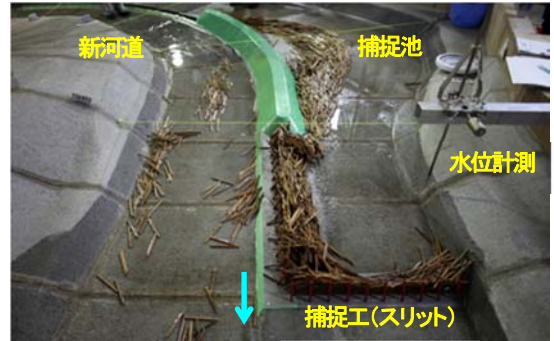
図-4 実験終了時の捕捉工周辺の流木堆積状況
