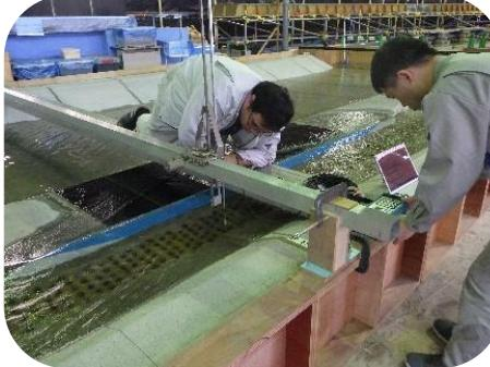
実験では、流速（PIV解析）・水位等を計測し、結果を整理してご提供します
