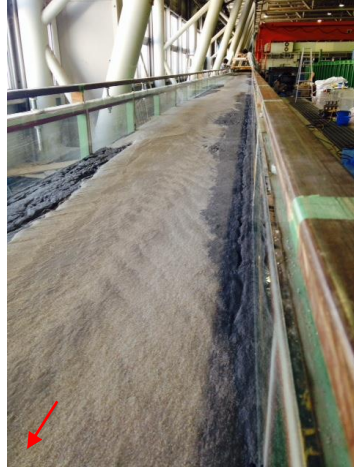
砂州移動によっても露出している岩盤床が侵食されます。
